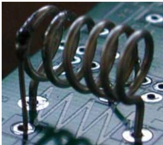
Setze die Spule auf ihren Platz, nachdem du sie genau auf die Breite gespreizt hast, die durch die Löt pads vorgegeben ist. Der Antennenanzapf wird aus 0,6mm CuAg hergestellt. Er erfolgt nach 3/4 Windungen im kalten ende der Spule. Das ist exakt auf halber Höhe der erstenn Windung von der Platinenkante aus gesehen, wenn die Spule richtig herum gewickelt wurde.
