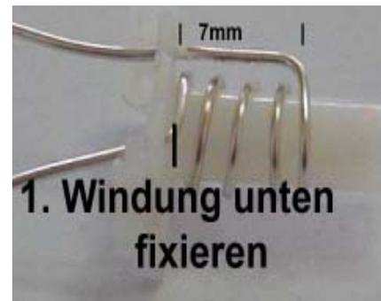
Schiebe die Spule vorsichtig wieder auf den Spulenkörper. ACHTUNG, jetzt nicht PIN 2 und 4 vertauschen. Das untere Ende muss in das Loch für PIN 4, das obere in das Loch für PIN 2. Die Wicklung wird jetzt ganz runter zur Bodenplatte hin justiert und die erste Windung direkt an der Bodenplatte mit einem Tropfen Epoxykleber fixiert.
