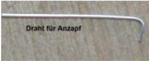
Wenn der Kleber ausgehärtet ist, wird der Anzapf hergestellt. Schneide ein 2cm Stück des 0,6mm CuAg Drahtes ab und biege die oberenn 2mm rechtwinklig ab.
