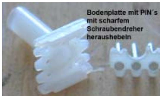
weil diese Spulen beim Hohentwiel direkt mit den Drahtenden in die Platine gelötet werden um eine höhere Güte zu erhalten. Die Bodenplatte dieser Spulen besteht aus zwei Teilen. Der eigentliche Stifthalter kann leicht heraus gebrochen werden, wenn man mit einem scharfen Schraubendreher
