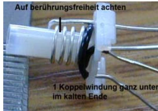
L 4 und L5 sind im Prinzip genauso aufgebaut wie L3 bis L8, sie bekommen aber zusätzlich eine Koppelwindung aus isoliertem Draht in das kalte Ende der Spule gelegt.
