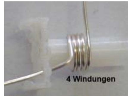
Stecke den Draht durch das PIN 4 Loch der Bodenplatte so dass etwa 15mm außerhalb der Platte bleiben und winde den Draht 4 mal um den Spulenkörper.
