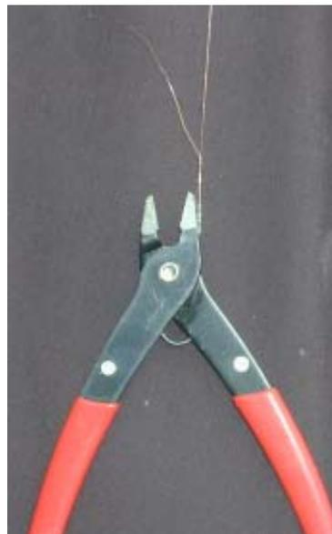
Nimm die benötigte Länge des Spulendrahtes, mach an ein Ende eine Schlaufe (Knoten). In die Schlaufe wird die Zange gehängt.
