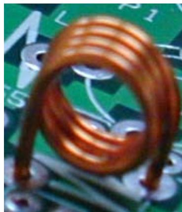
Bei diesem dicken CuL-Draht kann der lack nicht wie bei dem 0,1mm Draht direkt durch den Lötvorgang entfernt werden. Die Drahtenden müssen sehr sorgfältig vom Lack befreit werden. Bei dem 1mm Draht geht das sehr gut mit einem Teppichmesser (Cutter). Achte darauf, dass der lack wirklich rundherum entfernt ist. Verzinne die blanken Enden bevor du die Spule einbaust. Kontrolliere ob dass Zinn auch wirklich rund um den Draht gekauft ist. (HINWEIS: man findet immer wiederr dern Tipp, den Lack mit
