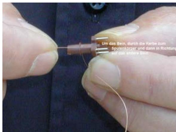
Das andere Ende des Drahtes wird mit drei Windungen um das Beinchen des Spulenkörpers geschlungen, mit dem man laut Baumappe beginnen soll. Die Beinchen von Neosid Spulenkörpern sind extra sehr rau, damit der Draht nicht rutschen kann.
